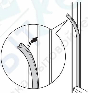
5. Удалите соответствующую деталь крышки петли (E). Следует удалить правую деталь, если дверная петля находится справа, противном случае - левую.
