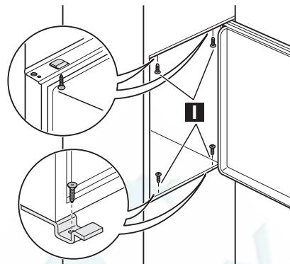
4. Установите уплотняющую прокладку между холодильником и прилегающим кухонным шкафом.
