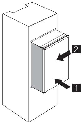
2. Отрегулируйте положение прибора в нише.
